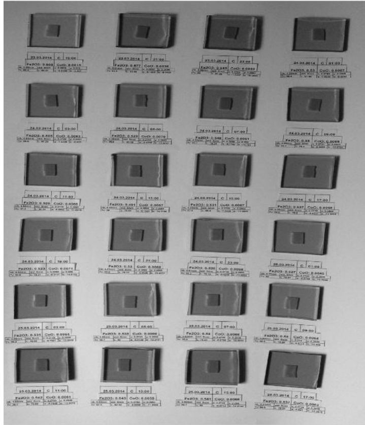
Şekil 1. Yeşil renkli camdan mavi renkli cama geçiş numuneleri (TR-2, 23-25.03.2014)
