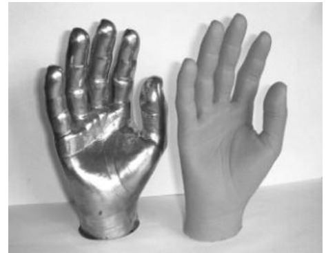
Şekil 2. Kalıp üzerine nikel ile elektrokaplama
